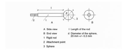
Figure A.1. Test rod
